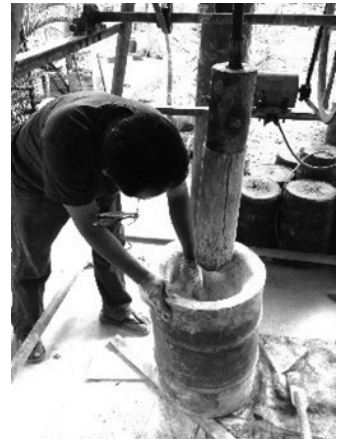
図2 サーコン氏によるランナー漆喰製法(機械)
