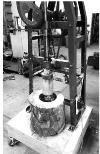
図 12 手動餅つき機によるランナー漆喰製法
