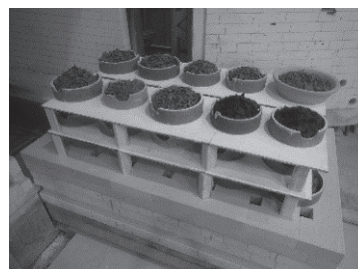
図 17 炉内焼成の窯入れ
